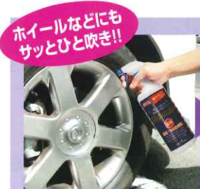
鉄粉落としを吹きつけます。鉄粉が液と反応して紫色に。
