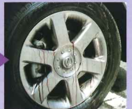
鉄粉落としを吹きつけます。鉄粉が液と反応して紫色に。
