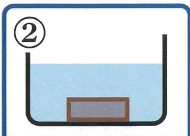
② 対象物を希釈した液剤に浸漬する。錆の度合いによって浸漬時間を変える。
