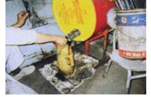
燃料タンクの床面での油吸着 (S-2025、SO-2747)
